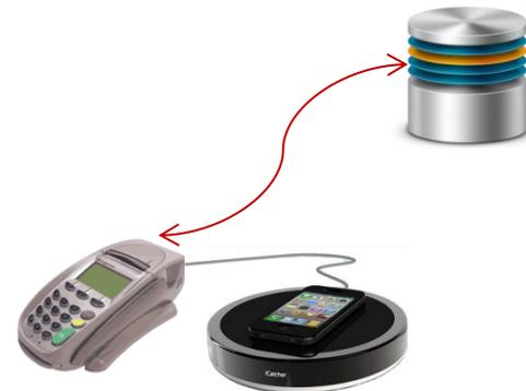
Il Cliente appoggia il telefono cellulare sull' **iCatcher** che ne estrae il codice **IMEI** passando l'informazione al **POS**. Quest'ultimo riconosce la transazione **iCatcher**, e si collega alla corrispondente **Banca Dati** per identificare il Cliente e il tipo di pagamento che questi ha associato alle sue transazioni mobile.
