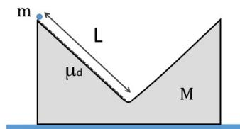
a) Il profilo è fisso e la particella si trova inizialmente in quiete all'estremo superiore sinistro da dove, in un dato istante, inizia a scivolare. Si calcoli l'accelerazione di caduta lungo il piano.
