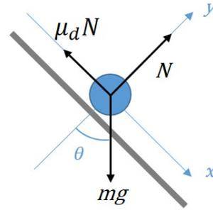
con  $\sin \theta = \cos \theta = \sqrt{2}/2$ . Dalla seconda equazione si ricava la reazione vincolare  $N = mg \cos \theta$ , che inserita nella prima permette di calcolare l'accelerazione:
