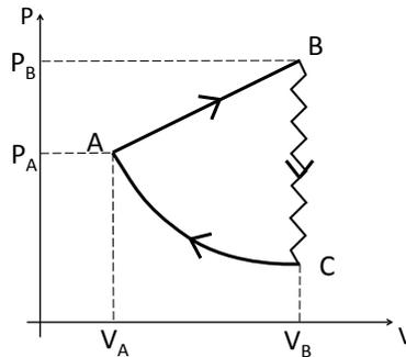
**e)** Il ciclo è formato da un'espansione quasistatica caratterizzata da una relazione lineare tra pressione e volume (trasformazione  $A-B$ ), da uno scambio di calore (irreversibile) con un termostato che porta la temperatura del
