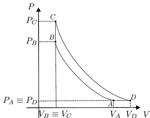
e) Per calcolare il rendimento della macchina termica in esame dobbiamo determinare il calore assorbito sul ciclo, che in questo caso è
