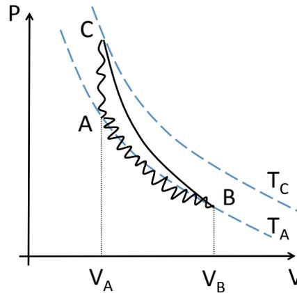
**c)** Per calcolare il lavoro compiuto sul gas durante la ricomprensione possiamo sfruttare il fatto che nelle trasformazioni adiabatiche il calore scambiato è nullo utilizzando il primo principio:
