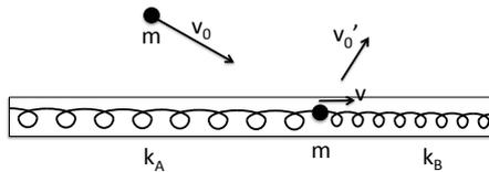
b) L'urto è elastico quindi si conserva l'energia cinetica del sistema. Inoltre sappiamo che la guida orizzontale è rigida e vincolata e permette alla massa al suo interno di muoversi unicamente lungo l'asse  $x$ . Questo implica la conservazione della quantità di moto esclusivamente lungo l'asse  $x$ . Eliminando direttamente anche le masse dalle equazioni, visto che sono uguali per le due
