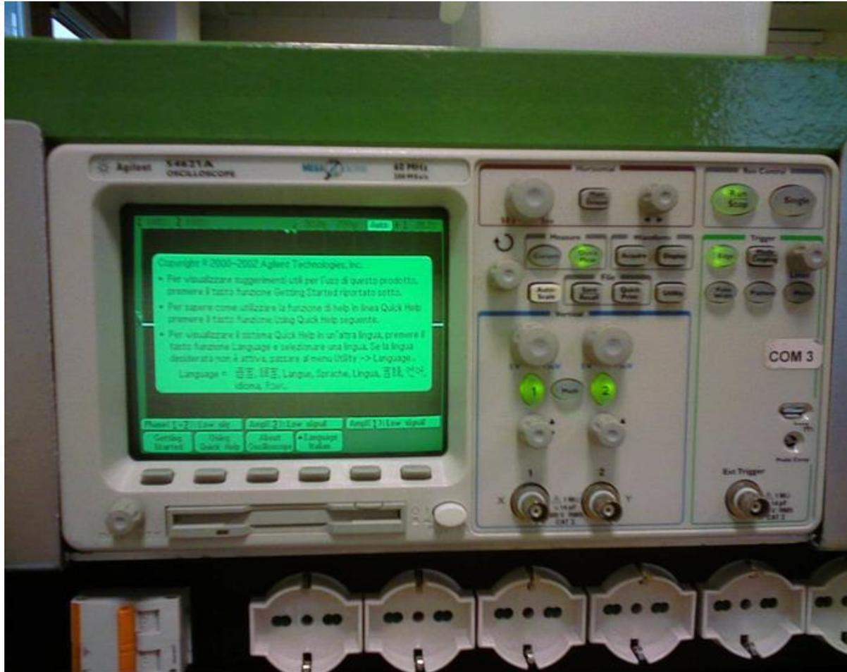
L'oscilloscopio è uno strumento che visualizza su uno schermo l'andamento di una tensione in funzione del tempo. Con questo strumento si possono eseguire misure della forma del segnale di ingresso ( periodo, ampiezza...)
